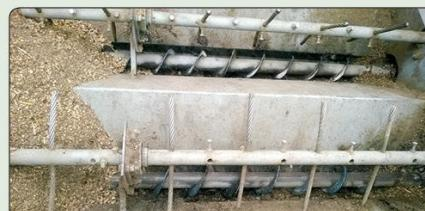
шnekами у топку. Автоматика контролює температуру теплоносія, що надходить до сушарки, і регулює подачу палива та повітря у зону спалювання. Топка
